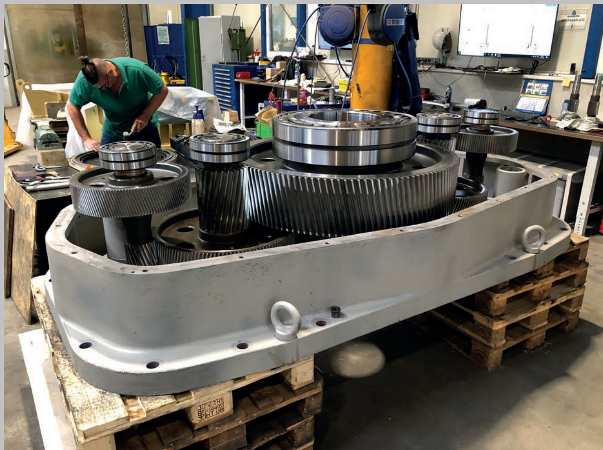
Totalrenovering av Santasalo omrörarväxellåda.
