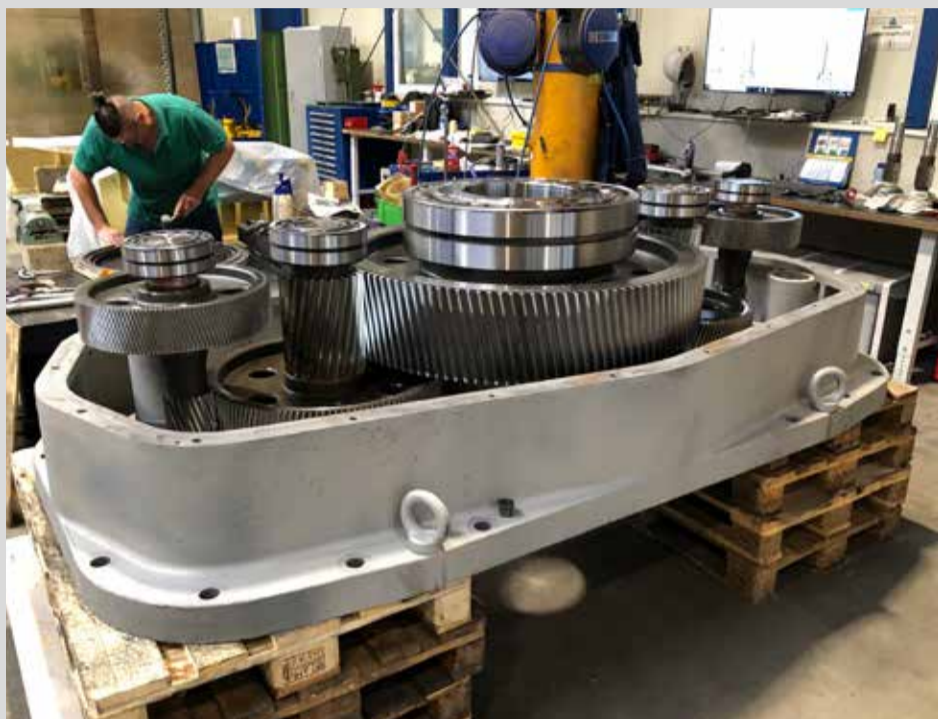
Totalrenovering av Santasalo omrörarväxellåda.
